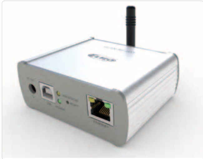
Obr. 1 eLAN-RF-003: Konvertor na základnú komunikáciu s RF zariadeniami prostredníctvom počítačových drôtových a bezdrôtových sietí. Premieňa dátové príkazy na RF signál pre jednotlivé zariadenia.
