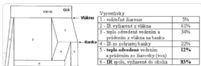
Obr. 2 Výkonová bilancia obvyčajnej žiarovky PHILIPS GLS 100 W [3]
